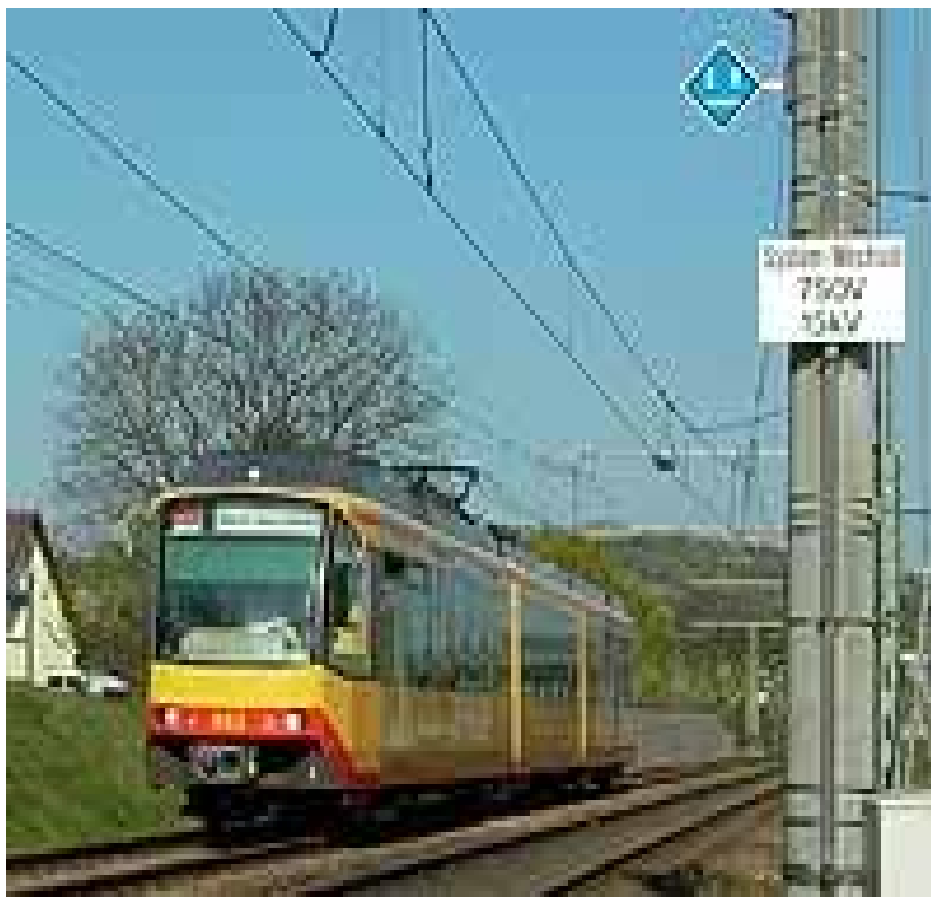
Il tram-treno sulla ferrovia DB in corrispondenza del cambio di tensione di alimentazione tra rete ferroviaria (15.000 Volts 16 2/3 hz) e rete tranviaria (750 Volts)
